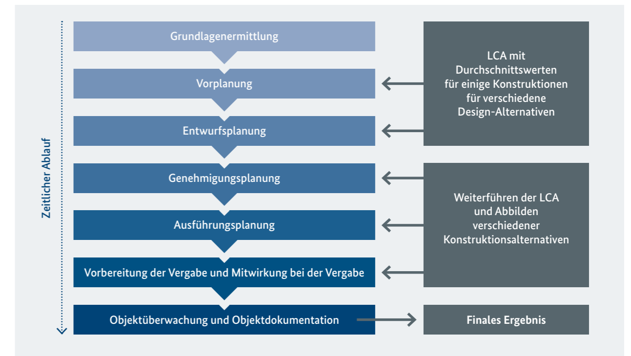
Abbildung 4: Wiederholte Durchführung der Lebenszyklusanalyse zu verschiedenen Zeitpunkten im Planungsprozess (© BIM.Hamburg nach Deutsche Gesellschaft für Nachhaltiges Bauen, 2018)
