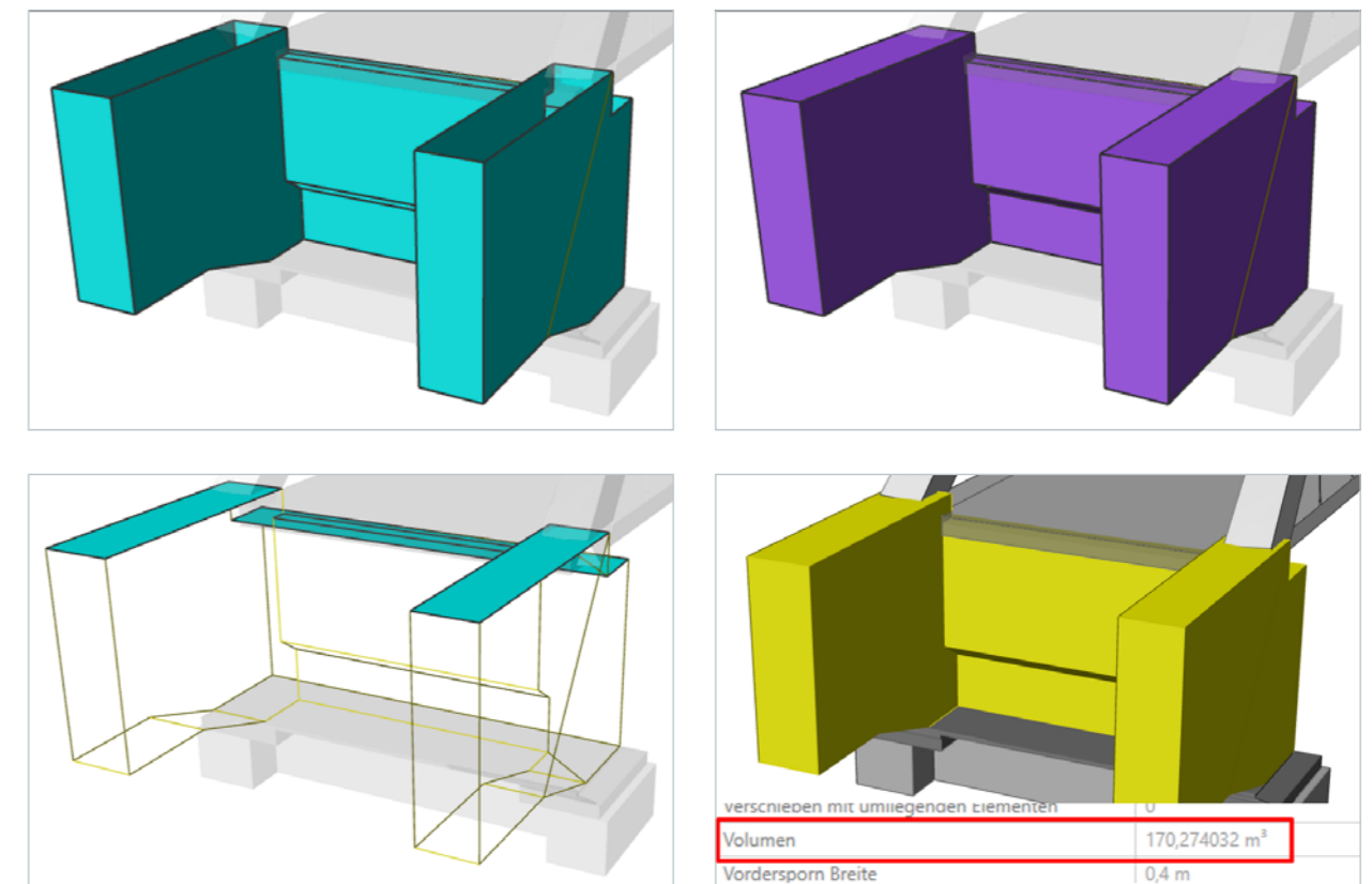
Abbildung 8: Möglichkeiten der Mengenberechnungen für ein Bauteil einer Brücke
