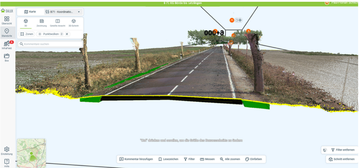
Abbildung 4: Beispiel Soll- Ist-Vergleich zwischen IFC-Modell und Punktwolke auf einer CDE (Quelle: Landesstraßenbaubehörde Sachsen-Anhalt, JOHANN BUNTE Bauunternehmung SE & Co. KG)
