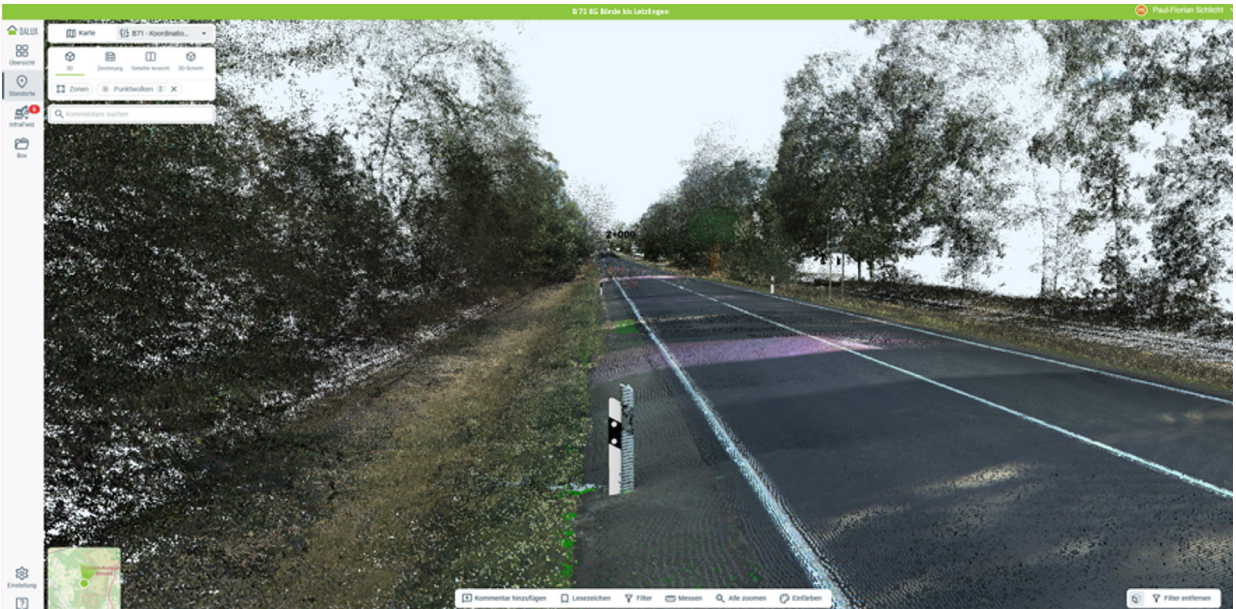
Abbildung 3: Beispiel Soll- Ist-Vergleich zwischen IFC-Modell und Punktwolke auf einer CDE einfügen und die folgenden Abbildung weiter Hochzählen.
